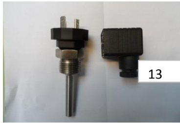
Indskruningsføler med PT100 element. monteret med 3 pol. Ventilstik fra Hirschmann. Gevindtilslutning 1/2 RG. Fremstillet i AISI 316, rustfast rør og nippel.
