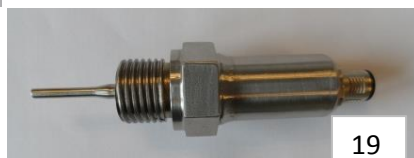
Iskruningsføler med 1/2" gevindtilslutning Indbygget transmitter og M8 stik. Følerør er reduceret i dimension for hurtige reaktion.
